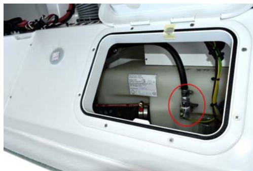
Vanne d'alimentation carburant : Située directement sur le réservoir
