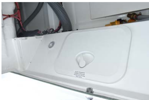
Vanne d'alimentation carburant : Située directement sur le réservoir
